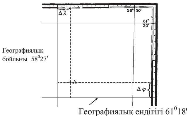
7.5 сурет. Топографиялық картаның минуттық бұрыштамасын пайдаланып А нүктесінің географиялық координатын анықтау
